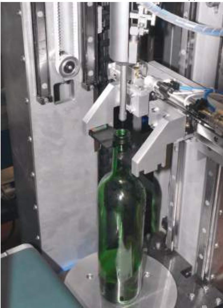
estación de medición de espesor de pared
